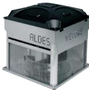
Roof fan • 100 m 3 /h to 27000 m 3 /h • Upto 800 Pa • 400°C - 2h
