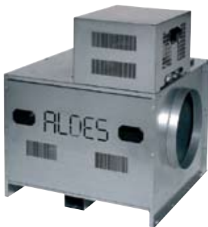
Cabinet fan • 1000 m 3 /h to 32000 m 3 /h • Upto 1250 Pa • 400°C - 2h
